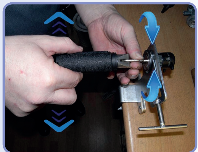
Bei der Impressionstechnik wird der eingespannte Schlüssel nach rechts oder links gedreht um die Stifte zu blockieren. Danach werden durch hoch- und runterschaukeln des Schlüssels Impressionsabdrücke auf den Schlüssel erstellt.
