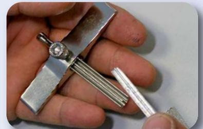
Fertig präparierte Folie auf dem Trägerschlüssel fixieren
