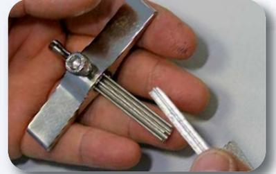
Fertig präparierte Folie auf dem Trägerschlüssel fixieren
