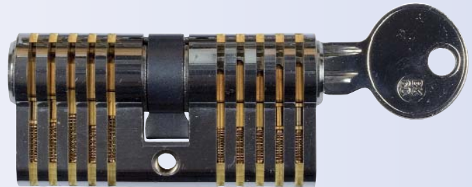
Modell "Standard" mit 2 Pilzkopfstifte als "Anti Picking" Maßnahme
