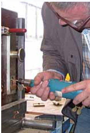
Bilder unten: Schweißtreibende Arbeit beim Versuch, einen KESO-Zylinder zu fräsen. Bild rechts: Klaus Förster mit dem "Nagel"
