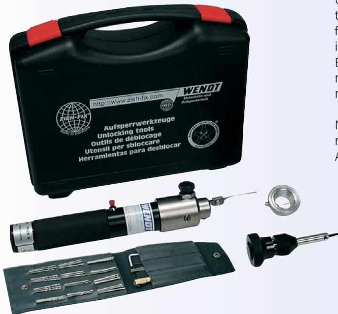
Unsere akkubetriebene elektrische Sperrzeugpistole arbeitet nach dem Perkussionsprinzip. Die erforderliche Schlagfrequenz sowie die Schlaghärte des Picks werden jedoch im Gegensatz zur manuellen Sperrzeugpistole über einen Exzenter ausgelöst. Dadurch wird einfaches Aufsperrn mehrstiftiger Stift- und Scheibenzuhaltungsschließzylinder möglich.
