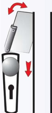
Ziehen Sie mit der einen Hand den Türknauf, mit der anderen Hand führen Sie die Türfallenöffnungskarte mit Hin- und Herbewegungen zwischen Türblatt und Türrahmen ein.
