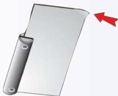
Biegen Sie eine Ecke der Türfallenöffnungskarte, damit sich diese leichter zwischen Türblatt und Türfalz einschieben lässt.
