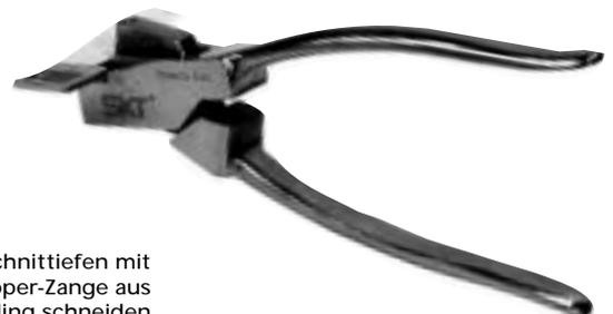
Einschnittiefen mit der Clipper-Zange aus dem Rohling schneiden
