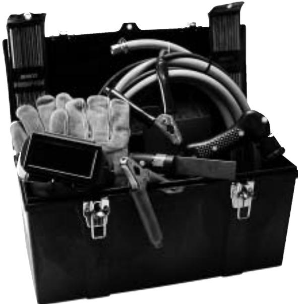
Ab sofort wird die Thermo-Lanze „HOT SHOT“ in neuer Ausführung geliefert. Der in der neuen Transportbox enthaltene Sauerstoffschlauch mit Handgriff wurde verlängert, dadurch ergibt sich ein größerer Arbeitsbereich. Weiterhin im Set enthalten sind Massekabel und Zündkabel mit „Kratzplatte“, ein Lederschild, ein Paar Schweißhandschuhe, 9 Stück Brennstäbe 6,35 x 450 mm, 6 Stück Brennstäbe 9,35 x 450 mm, 4 Stück Spannzangen im Ø 4,76 mm, Ø 6,35 mm, Ø 9,35 mm und Ø 12,7 mm sowie eine Schutzbrille.
