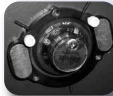
Positionieren Sie die Magnet-Grundplatte um die Wählscheibe
