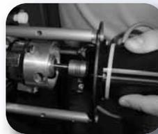
Stecken Sie den Motorantrieb auf die Adapterhülse
