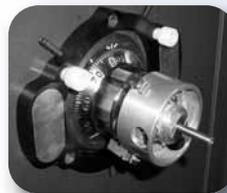
Befestigen Sie die Adapterhülse mit dem Spannfüßerschlüssel auf dem Zahlenknopf
