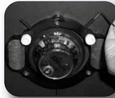
Ziehen Sie mit dem Inbusschlüssel die Befestigungsschrauben handfest an
