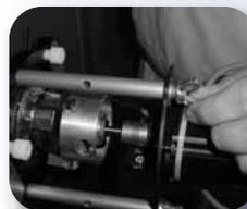
Schrauben Sie den Motorantrieb mit den Flügelschrauben fest
